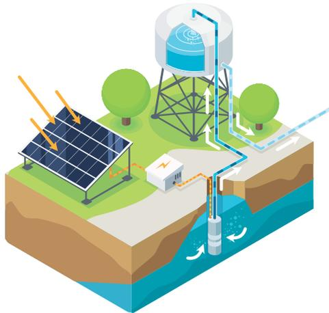
Sono stati installati due impianti di dimostrazione, uno in Mozambico (fiume Incomati) e uno in Sudafrica (fiume Klip). L'obiettivo di tale sistema è disinfettare l'acqua nelle zone rurali remote africane, in modo sostenibile e accessibile, producendo acqua potabile.
