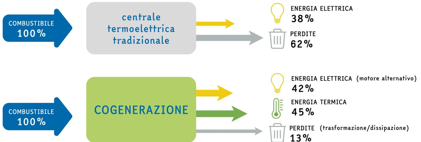
Generalmente i sistemi CHP sono formati da un motore primario, un generatore, un sistema di recupero termico ed interconnessioni elettriche.
